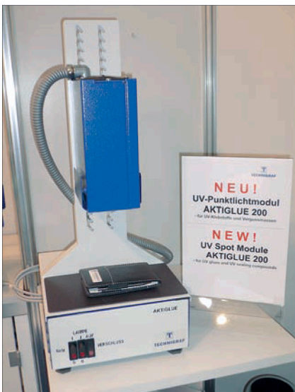
UV-Punktlichtmodell Aktigluue zur schnellen Trocknung von UV-Klebstoffen.
